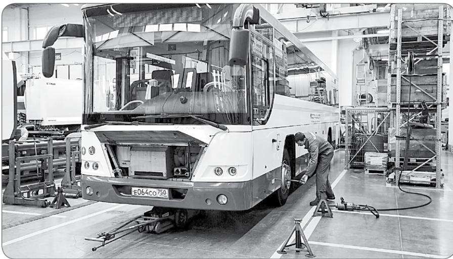
использования средств измерений. Речь идёт о визуальном осмотре узлов, агрегатов, механизмов и систем транспортного средства, тактильного и акустического анализа систем, проверки наличия запахов, свидетельствующих о возможной неисправности электрооборудования, топливной системы и охлаждения двигателя.
